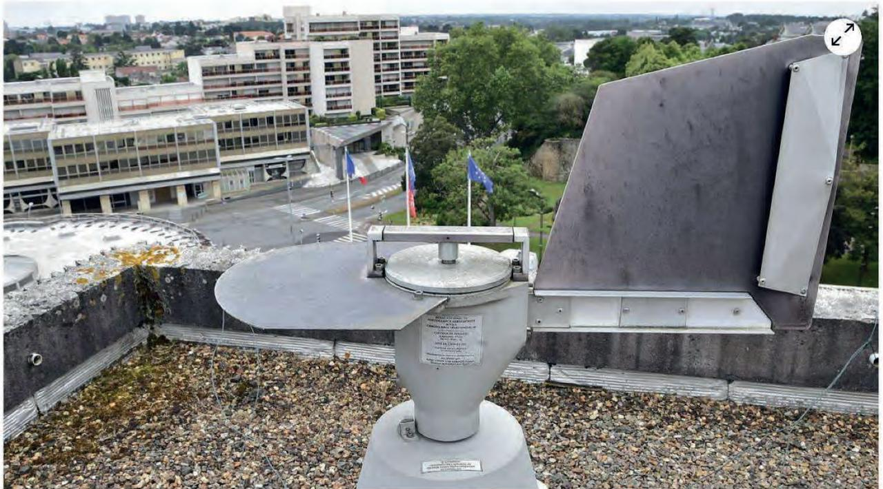
Voici le capteur installé sur le toit de la mairie. Il permet de mesurer précisément les pollens dans l'air. | CO – ÉTIENNE LIZAMBARD
